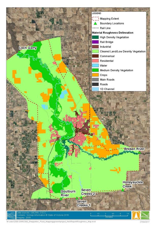
FIGURE 5-3 2D MATERIAL ROUGHNESS MAP
