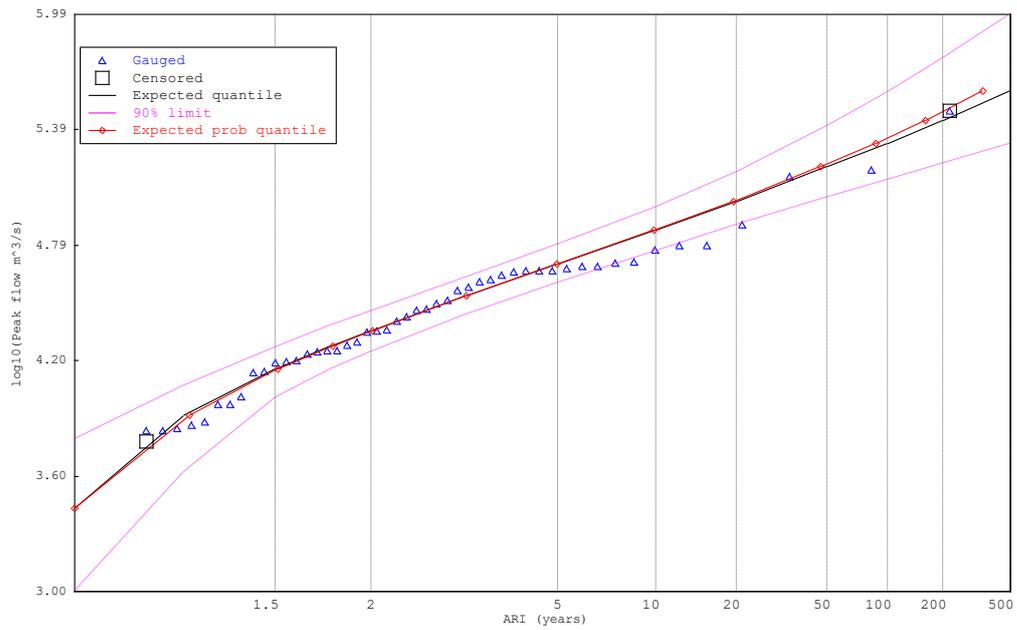
**FIGURE 4-6 GEV DISTRIBUTION FITTED TO ANNUAL SERIES FOR GOULBURN RIVER @ MURCHISON (405200), DELWP RATING CURVE, POST-BIG EILDON RECORD PLUS 1916**
