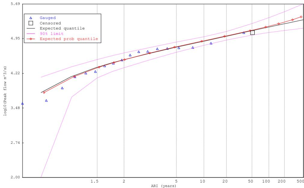
**FIGURE 4-5 GEV DISTRIBUTION FITTED TO ANNUAL SERIES FOR GOULBURN RIVER @ GOULBURN WEIR (405253)**
